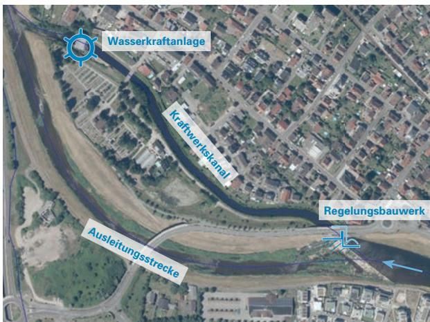
Abbildung 2-1: Ausleitungskraftwerk Rotenfels Murg
